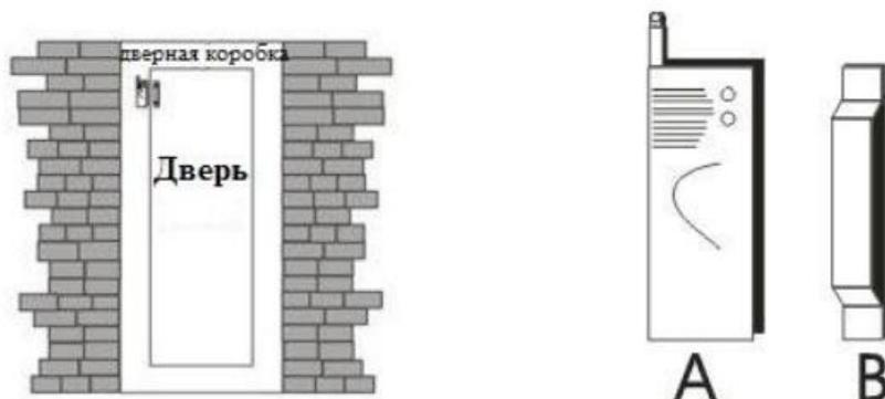
Поверхность двери должна быть ровной, сухой и очищенной от загрязнений для того, чтобы надежно прикрепить датчик на двухсторонний скотч, идущий в комплекте к датчику.
