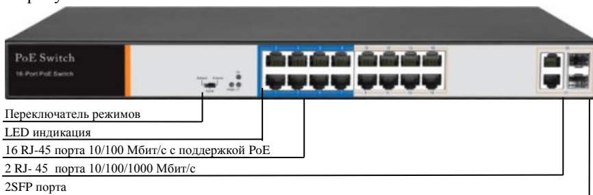
Рис. 1. Коммутатор Optimus UMG1-18/16P, вид спереди.
