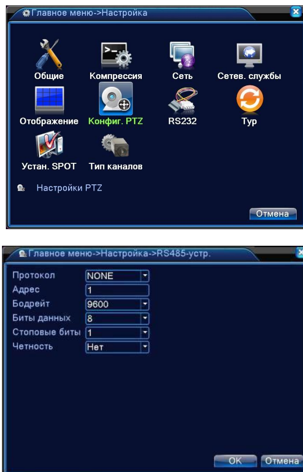
Рисунок 4.33 Конфигурация RS485 устройств в цифровом режиме.
